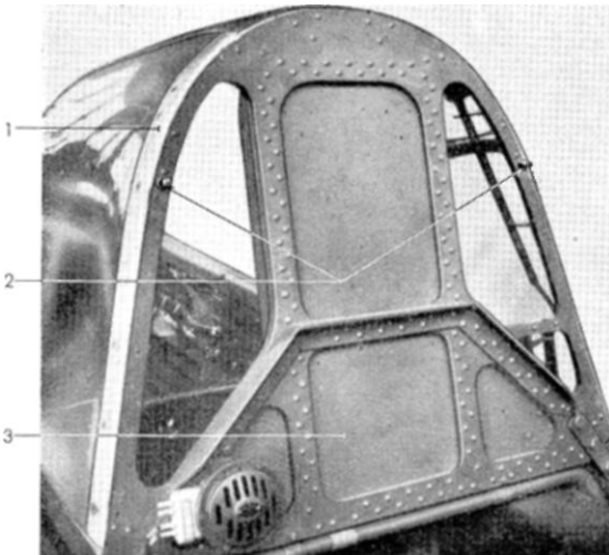
Abb. 10 Rüstmarken für Ausrichten in Flugzeug-Querachse
