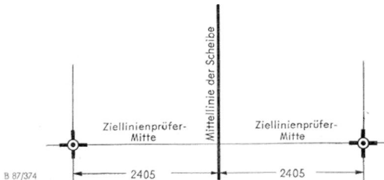
Abb. 11 Einstellscheibe für Ziellinienprüfer-Rohr
