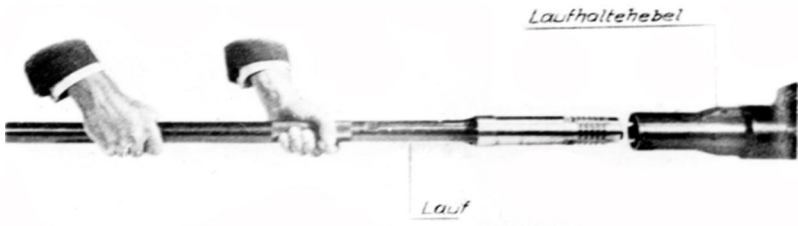
Abb. 52: Einsetzen des Laufes
