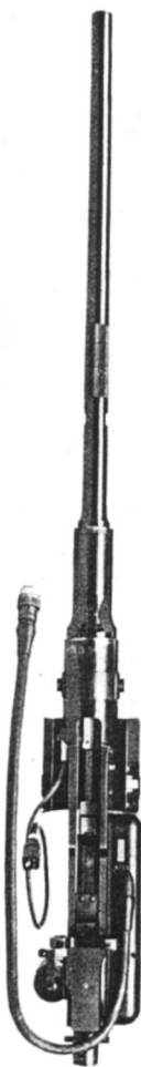
Abb. 3: MG 151/20 f. elektr. Zündung von unten gesehen
